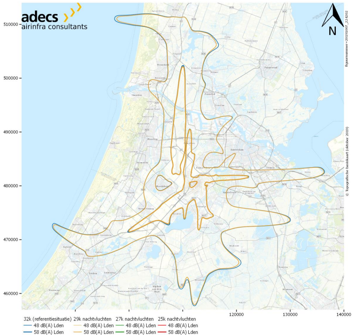
Figuur 7 De 48- en 58 dB(A) L_{den} -contouren van alle scenario's.
