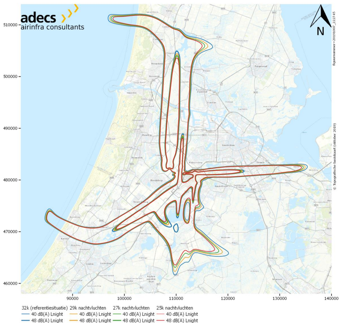
Figuur 9 De 40 en 48 dB(A) Night-contouren van alle scenario's.
