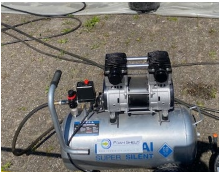
Foto 2: Compressor van Foamshield
